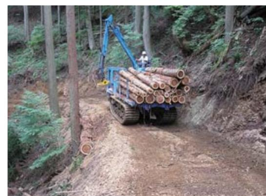
図2 高性能林業機械による木材搬出作業
