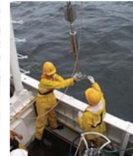
三重大学練習船勢水丸での伊勢湾海底泥採集。採泥には重錐式柱状採泥器を用いている。
