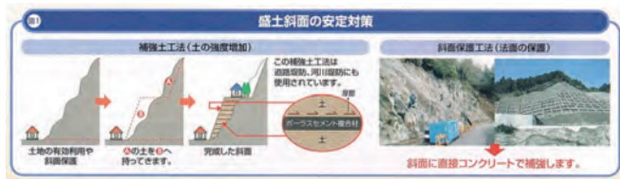
図1 斜面の補強・のり面保護
