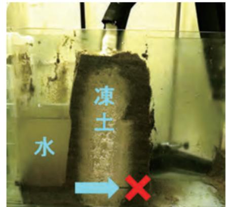
図2 凍土の遮水性の確認実験
