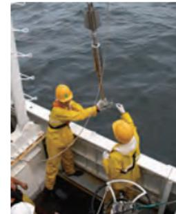
三重大学練習船勢丸での伊勢湾海底泥採集。採泥には重錐式柱状採泥器を用いている。
