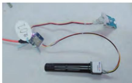
農家自作型IoTセンサ(二酸化炭素濃度計)
