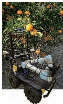
開発中の柑橘収穫ロボット
