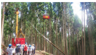
図1 架線系の林業機械による伐出現場
