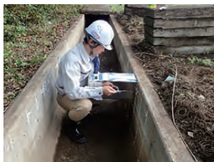
図1 空中超音波センサ計測
