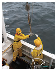
三重大学練習船勢水丸での伊勢湾海底泥採集。採泥には重錘式柱状採泥器を用いている。
