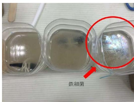
Fig. 25 鉄バクテリアの皮膜
