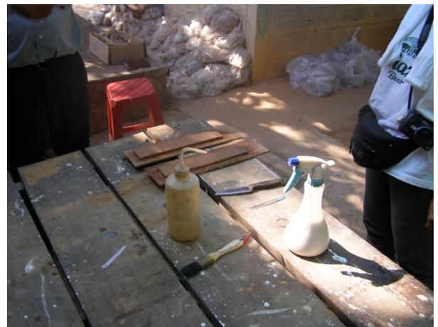
(26) 水溶性木工ボンドを5~20倍に薄め、1%相当の中性洗剤を加えた希釈溶液を噴霧。乾燥と噴霧を重ねて徐々に固化させる。
