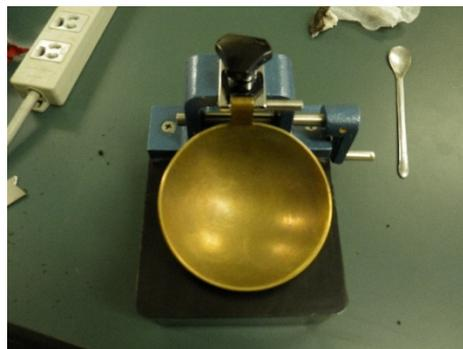
Fig 4-2 硬質ゴム台(液性限界測定器)
