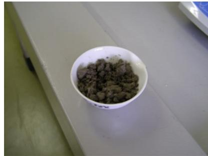
Fig.3-2 湿潤試料の質量測定
