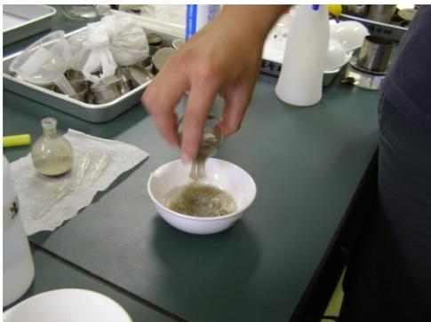
Fig.2-10 試料を蒸発皿にあける
