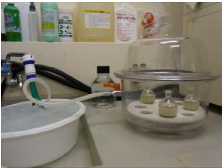
Fig.2-8 脱気装置接続図
