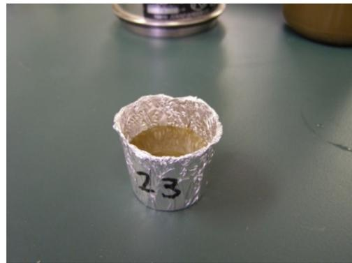
Fig.3-8 マクロピペットで採取した試料(蒸発皿に採取する方法もあり)
