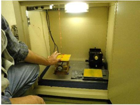
Fig12-9 中心軸の調整
