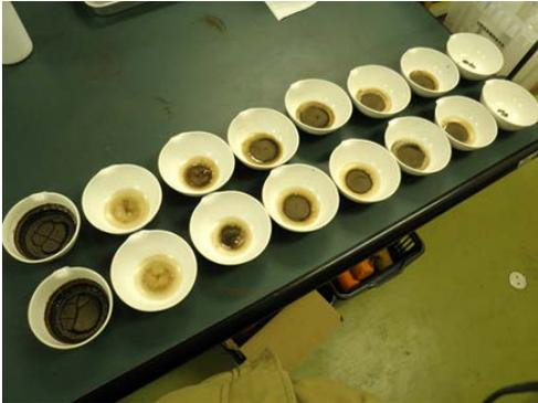
Fig.3-9 経過時間ごとに採取した試料(左上から残留試料、採取物①～⑥、沈殿試料の順)
