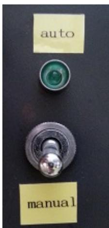
Fig.11-5 トグルスイッチ(下方向へ合わせる)
