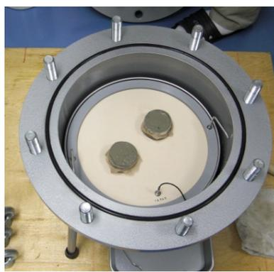
Fig.8-3 フィルターに試料を置く
