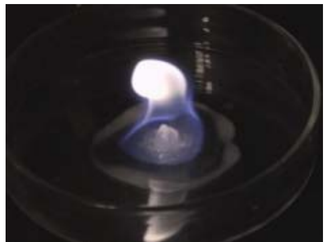
図8．ハイドレートレンズに火をつけた様子 図7の最も高温側に析出したレンズ状結晶を取りだし火をつけたところ、炎をあげて燃焼した。このことからレンズ状結晶が THF のハイドレートであることが確認できる。
